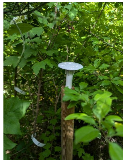
Abbildung 6: Sensor zur Messung der Luftfeuchte und -Temperatur.
